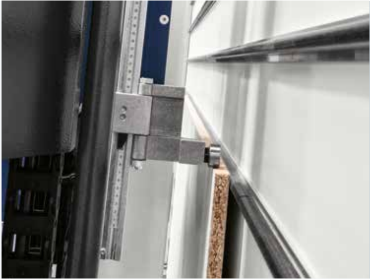
Dispositivo para la ejecución de cortes repetitivos en horizontal
