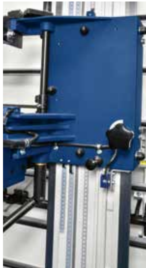
Escala métrica para cuotas de corte horizontales (est. v, vs, vsi)
