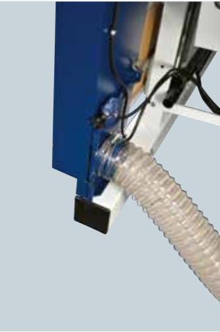
Colector de polvo posicionado en el lado derecho
