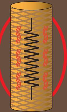
**Pratico gruppo caricamento e incollaggio del bordo.** La colla viene riscaldata rapidamente e omogeneamente dalle resistenze presenti sia nella vasca-colla che all'interno del rullo spalmacolla. Attraverso il PLC del quadro comandi è possibile mantenere costante la temperatura impostata anche quando la macchina è in stand-by. Due rulli copiatori pressano efficacemente ed uniformemente il bordo sul pezzo. La posizione del gruppo di pressione è regolabile comodamente dal fronte macchina.
