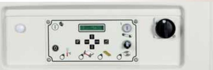
Attraverso il quadro comandi posto sul fronte macchina è possibile controllare tutte le funzioni in modo rapido ed intuitivo. In particolare, con il PLC è possibile escludere facilmente e comodamente la cesoia ed il gruppo intestatore per permettere la bordatura anche con strisce di massello dello spessore massimo di 5 mm.
