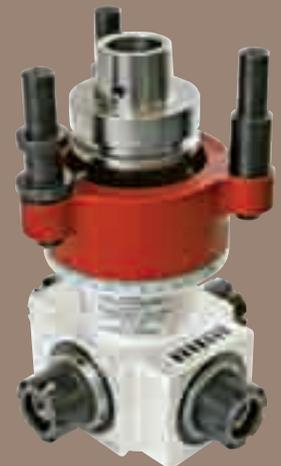
▶ Cabezal fresador con potencia constante (S6) 6,6 kW a cambio automático de la herramienta con sujeción HSK63F y con predisposición para sujeción cabezales
