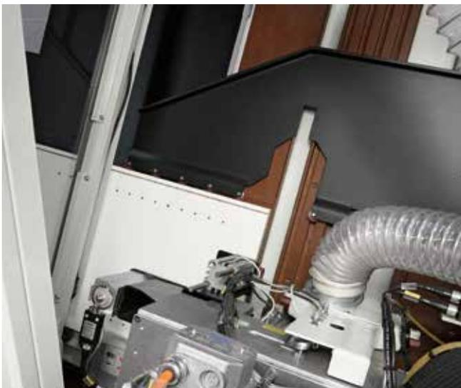
**Seguridad y fiabilidad**, gracias al grupo prensor superior que garantiza la adherencia de las piezas a la referencia inferior y la máxima precisión de mecanizado.
