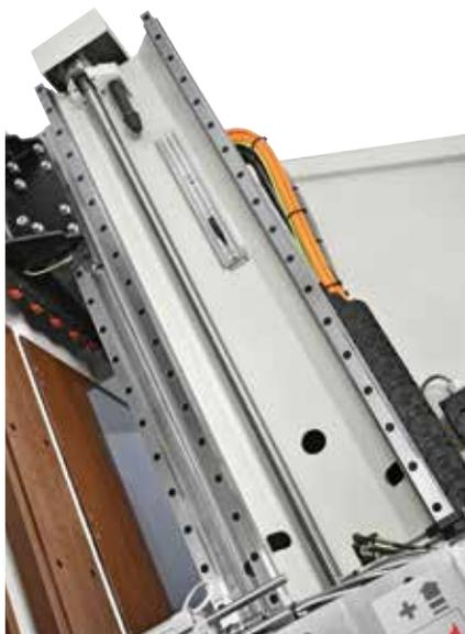
**Elevada precisión y velocidad de movimiento**, todos los grupos operadores están accionados por motores Brushless y se deslizan sobre guías prismáticas con patines de recirculación de bolas. **El sistema de movimiento** en X, Y y Z incluye tornillos de recirculación de bolas de alta precisión.
