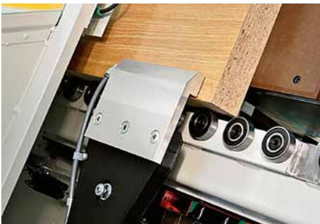
**Máxima estabilidad de la pieza y alta calidad de mecanizado** gracias a la pinza móvil con apertura flotante sin necesidad de regulación y a la mesa antirrayas de baquelita que garantiza alta calidad de mecanizado incluso paneles con superficies delicadas. Cero imprecisiones de taladro horizontal gracias a los dispositivos de presión diseñados específicamente.
