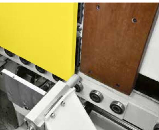
**Alto nivel de versatilidad**, el tope de referencia programable permite trabajar piezas incluso con las ya montadas o con fresados ya realizados.
