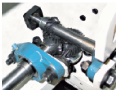
Trasmisione mediante ruote coniche Conical wheels transmission Transmission par roues coniques Antrieb über Kegelrad Transmisión mediante ruedas cónicas
